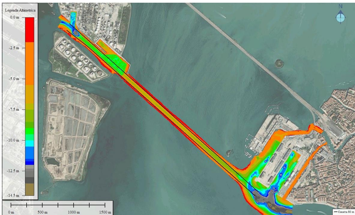
**Fig. 1.10 – Planimetria di stato attuale (rilievo di febbraio-aprile 2023) con indicazione dell'ingombro della cunetta di larghezza 80 m**
