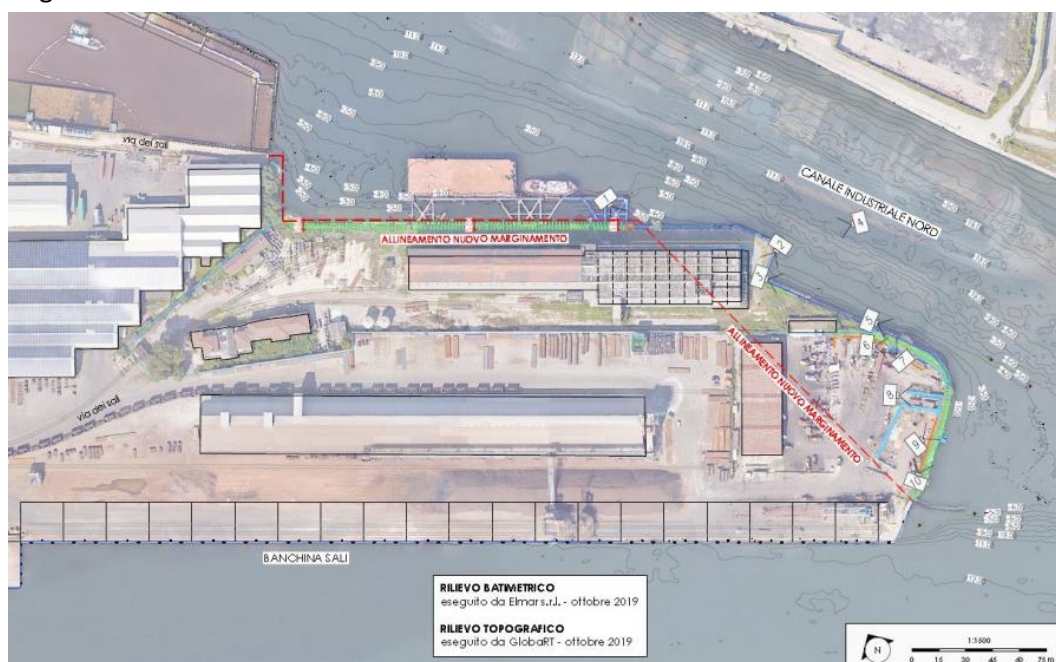
Figura 8: Ricalibratura (smusso) Molo Sali, previsto nell'ATF 2025 Marghera Nord.
