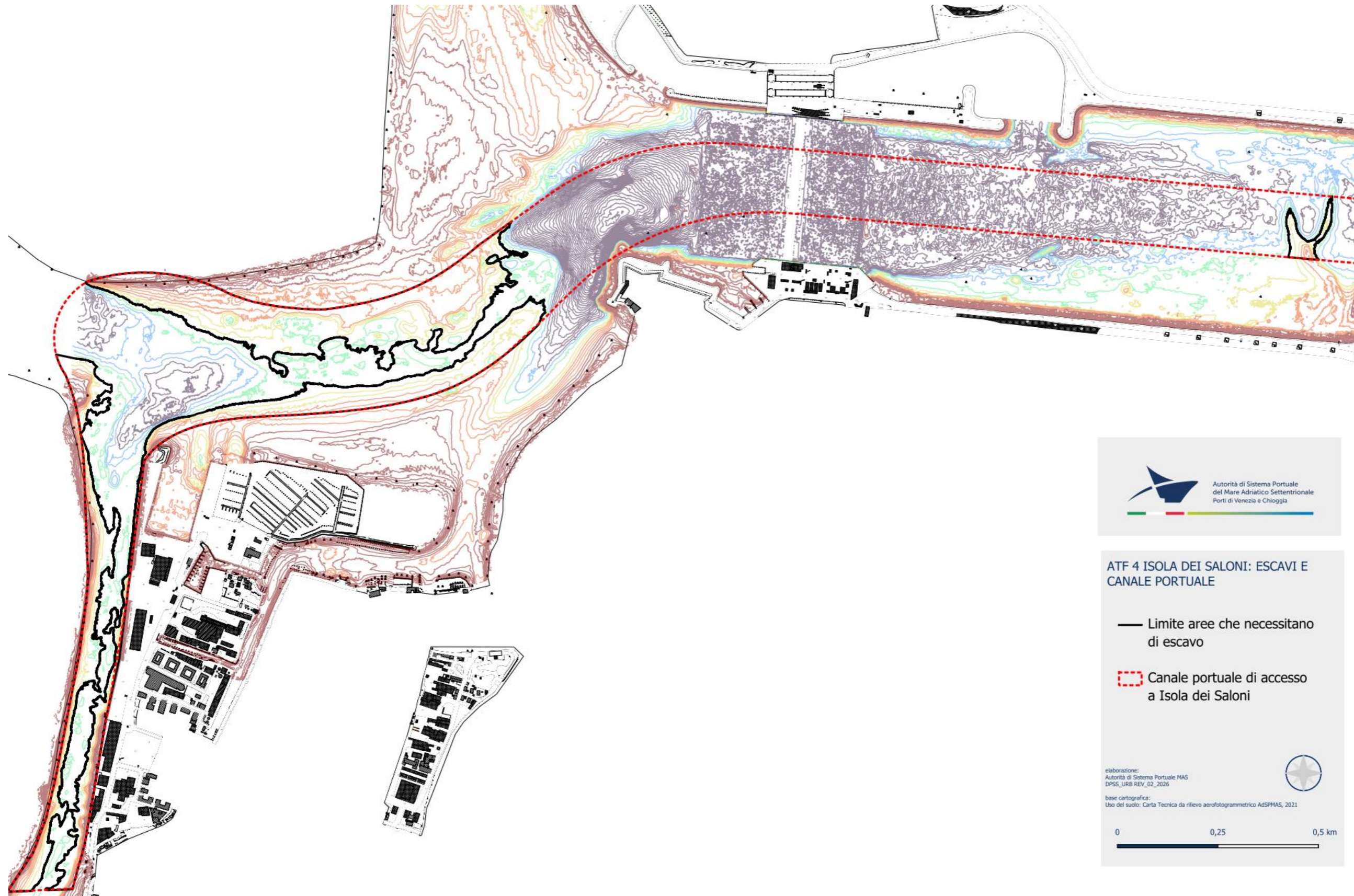
Figura 22: Riprofilatura canale di accesso fino all'Isola dei Saloni
